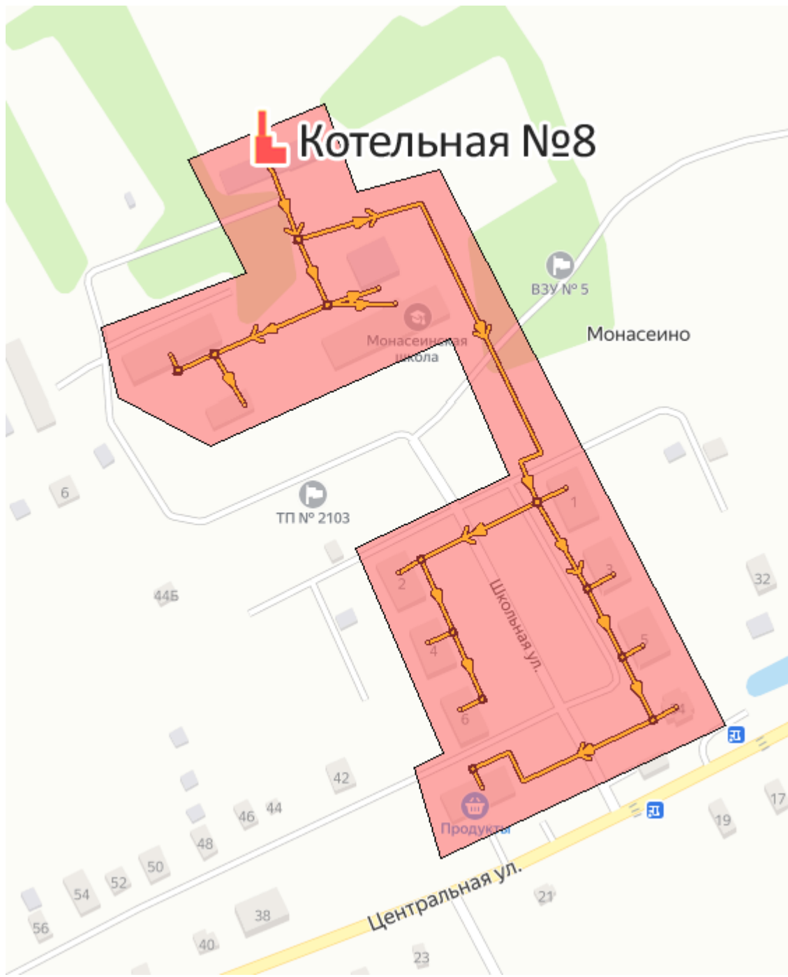
Рисунок 1.37 - Зона действия котельной №8 МП «Лотошинское ЖКХ»
