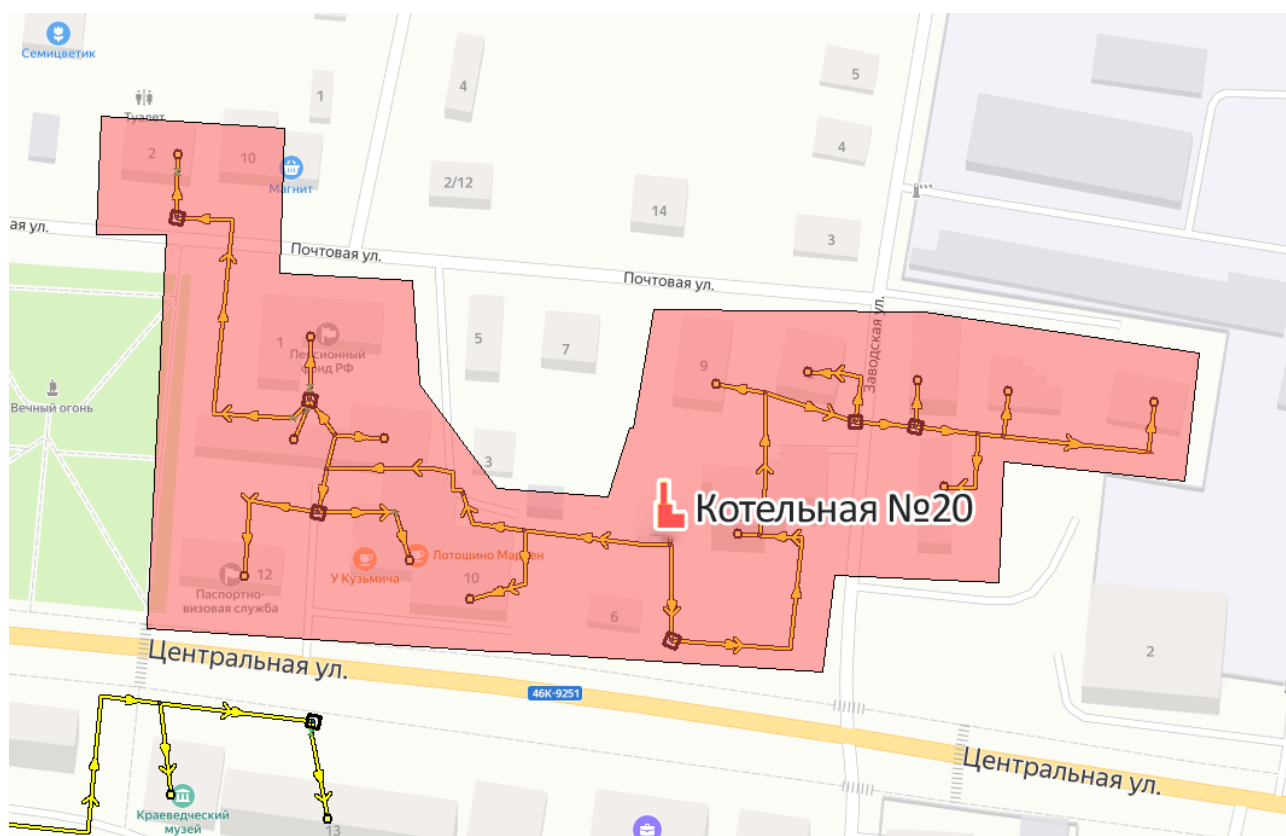
Рисунок 1.49 - Зона действия котельной №20 МП «Лотошинское ЖКХ»
